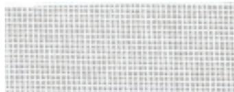
メッシュ構造により風圧による足場への負担を低減しつつ、塗料や粉塵などの飛散を防止します。
