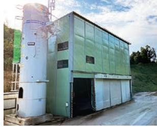
コンクリートを現場で作るための施設。トンネルやダム建設工事では、コンクリートを大量に使うため、購入するよりも現場で製造する方が割安になる場合が多く、バッチャープラントが使われます。
