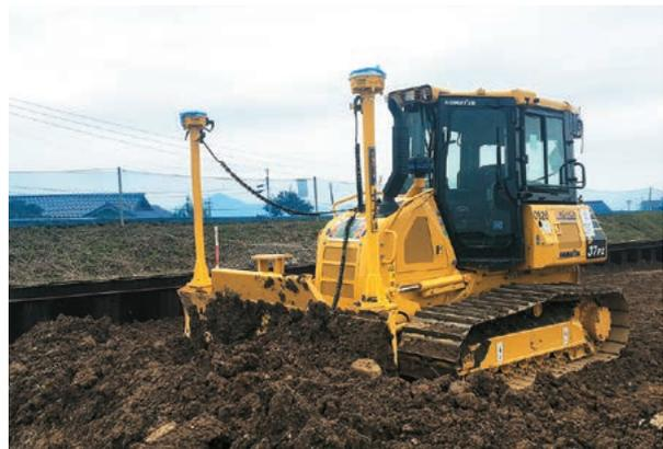
■ブルドーザーマシンコントロールシステム
